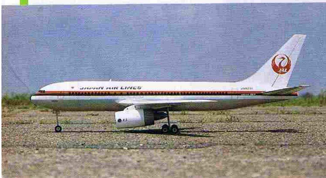
←BOEING767のサイドビュー。ダクテッド・ファンには大きなダウン・ストラストが付けられ、ノーズの頭上げを防いでいる
