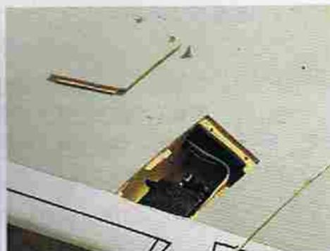
↑胴体上部のVHFアンテナを受信機のスイッチとして利用。上に引くとONになる
