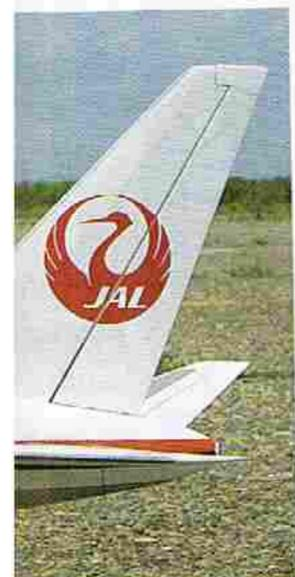
←リブに1.5mmバルサをブランク、フィルムで仕上げた垂直尾翼。おなじみのツルのマークもフィルムを切り抜いたもの
