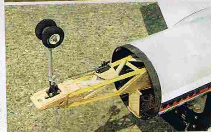
→機首部のボディを取り外すとノーズ・ギヤ取付部が現われる。この部分はヒノキのスパとバルサのトラスで組み、構造上、最も強度のあると思われる胴体中央部の胴枠と主翼のカンザシに接着されている。ノーズ・ギヤの荷重は全てその部分で受け持たせ、ボディはカバーの役割を果たすのみ。ノーズ基台はMK製、支柱は4mmφピアノ線にアルミパイプをかぶせたもの
