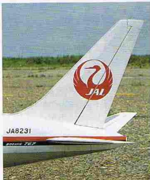
←リブに1.5mmバルサをブランク、フィルムで仕上げた垂直尾翼。おなじみのツルのマークもフィルムを切り抜いたもの
