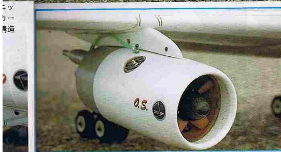
京商製ダクテッド・ファン・ユニット、エアロジェット20をほぼノーマルで使用。パーツのOS MAX-25VFは23000rpm以上を回す。エンジン後部の流線形の物が燃料タンク
