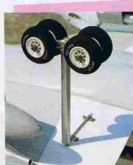
←メイン・ギヤは5mmφピアノ線にアルミパイプを通し、剛性を向上。タイヤはテトラ製スポンジ
