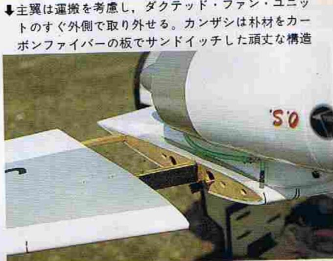
↓主翼は運搬を考慮し、ダクトド・ファン・ユニットのすぐ外側で取り外せる。カンザシは朴材をカーボンファイバーの板でサンドイッチした頑丈な構造
