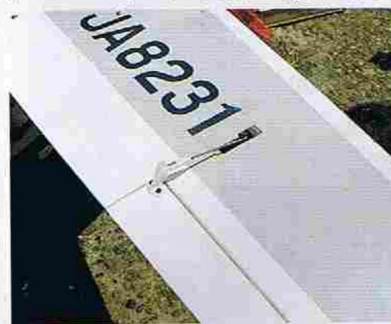
↓主翼は運搬を考慮し、ダクテッド・ファン・ユニットのすぐ外側で取り外せる。カンザシは朴材をカーボンファイバーの板でサンドイッチした頑丈な構造
