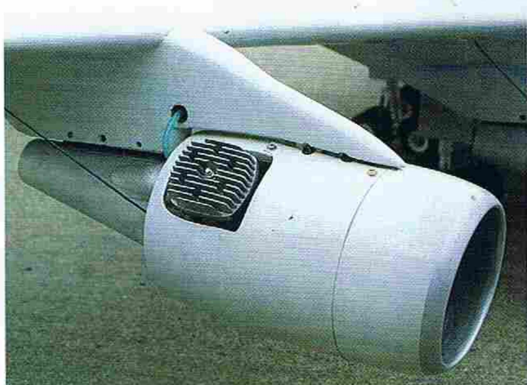
↑バルサの角材を張り合わせて整形したエンジン・ナセル。マフラーは実機のブライマリー・エキゾーストの形状に合わせて6061ジュラルミンで製作。内部にバッフル2枚を組み込み、消音対策も万全だ。
