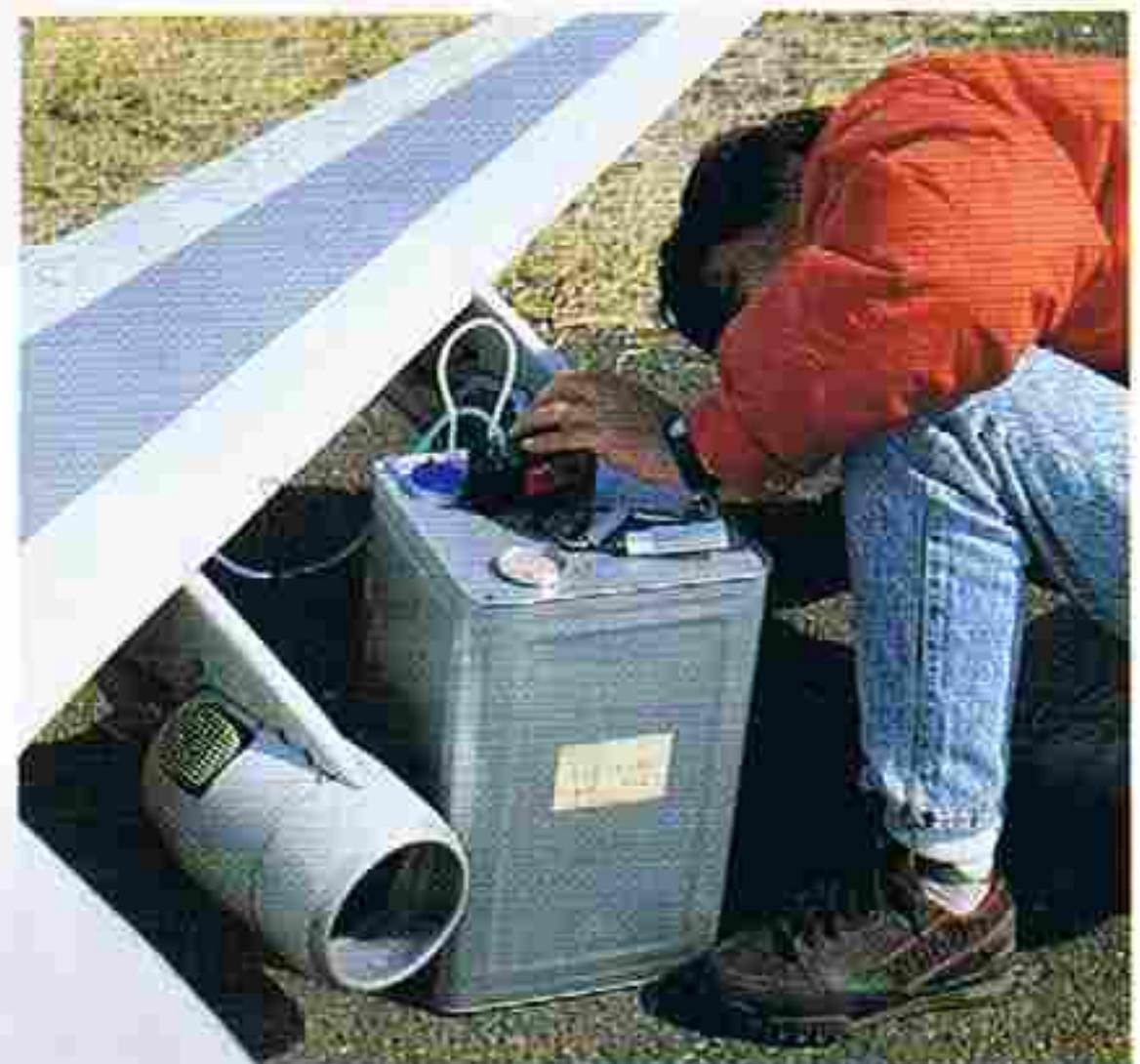
↑燃料は16l缶から補給する。エンジン排気量は合計で60cc。1回フライトしただけで1ℓ以上の燃料を消費してしまうのだ。
