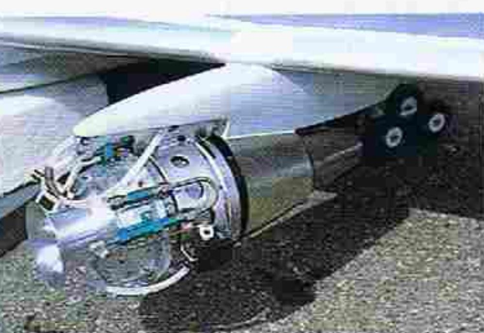
↑パワーソースには、三和電子機器（株）製のターボジェット・エンジン2基を使用。推力は1基あたり約5kgという。エンジン・ポッドはFRPで成型。
