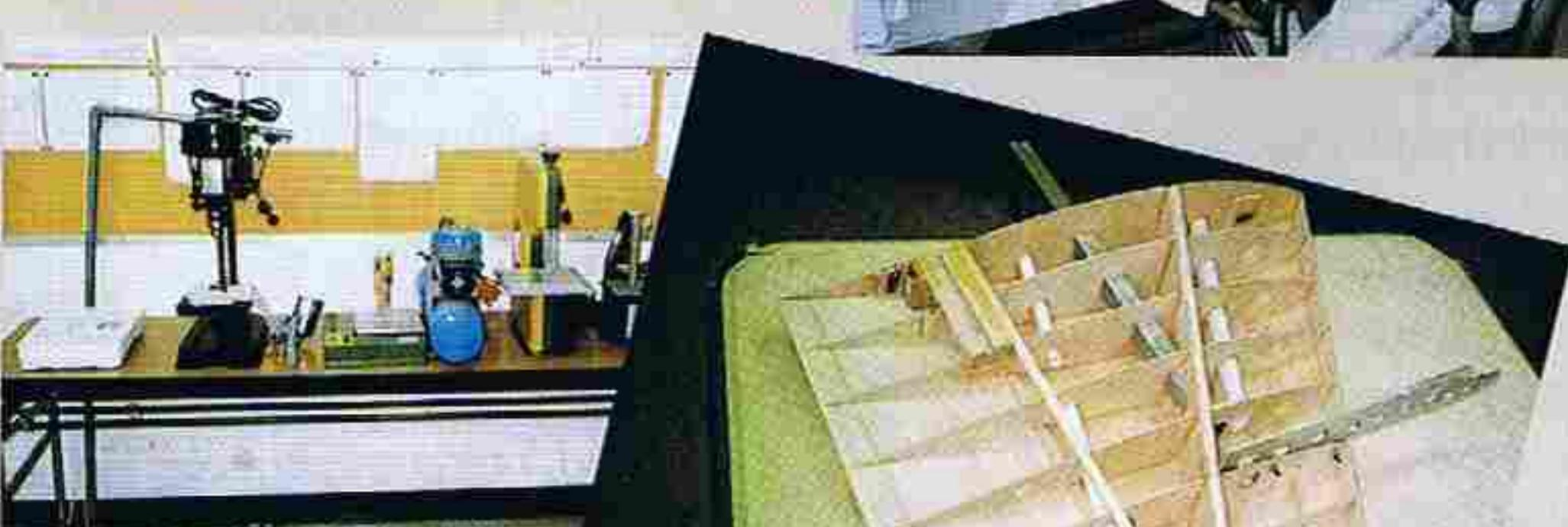
↑製作に使った電動工具類はいたってシンプル。中央が塗装用のコンプレッサー。
