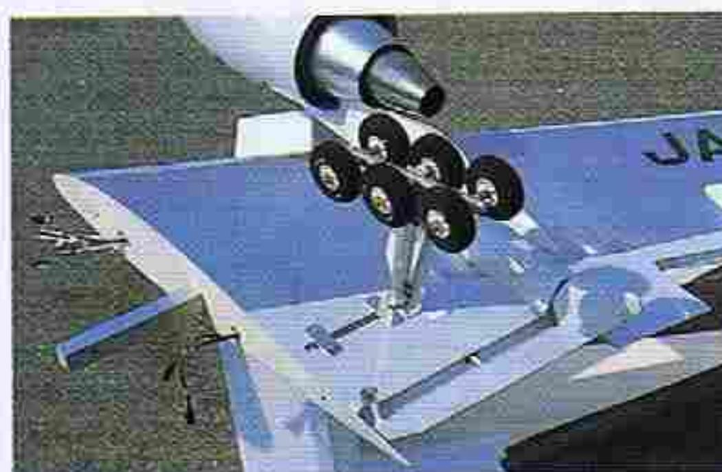
↑チルト機構を組み込んだ主脚。空中では実機と同じく3°後傾する。主翼のカンザシは6061、エンジン・パイロンは2024ジュラルミンで製作。フラップは着陸時に大きな効果を發揮した。
