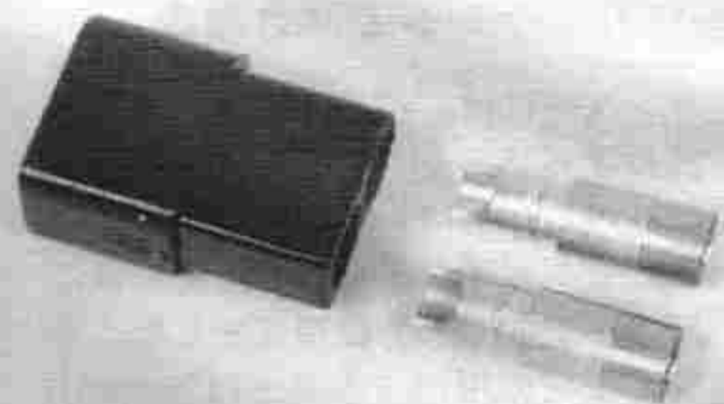
↑写真13/アストロフライト社のゼロロス・コネクター。
