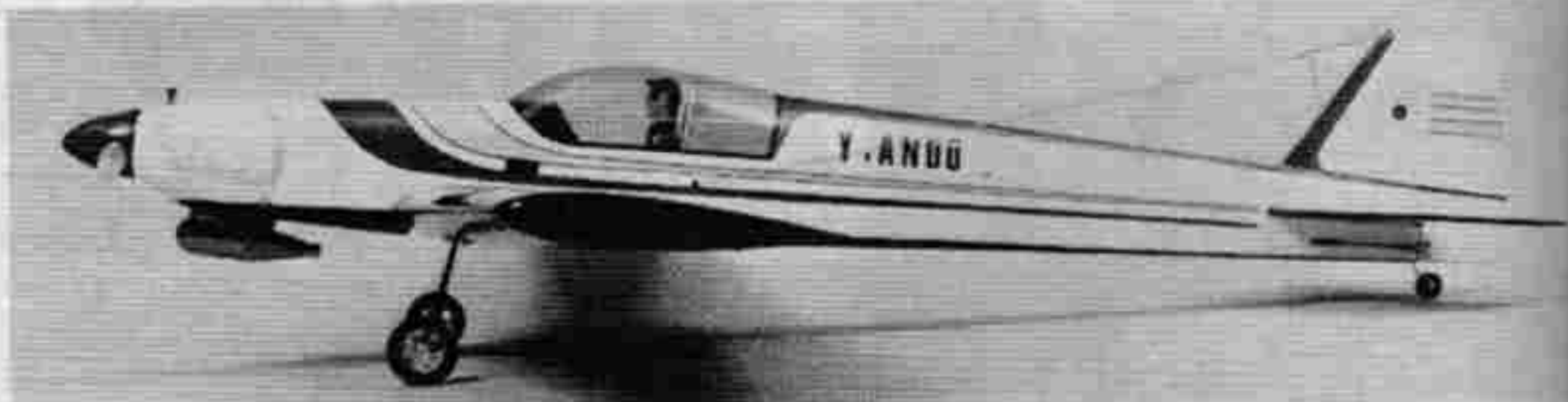
↑ビッグ・スーブラやスーブラ・フライ45アンリミテッドとは異なり、胴体プロフィールは細みでスッキリしている。スーブラ・フライ60の流れをくんだデザインだ
