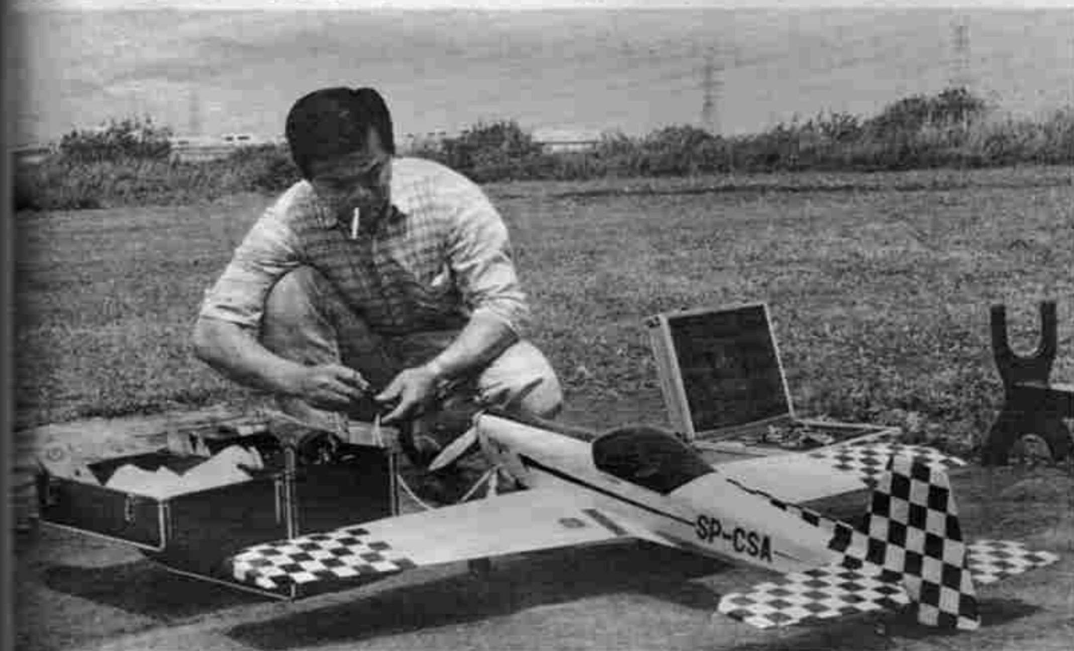
↑フライト準備中の筆者・安藤由隆氏。機体の重心は燃料がカラの状態に合わせている。
