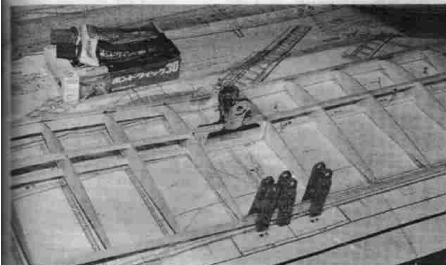
↑写真3 / 左右の主翼は必ずエポキシ系接着剤を使って接合する。
