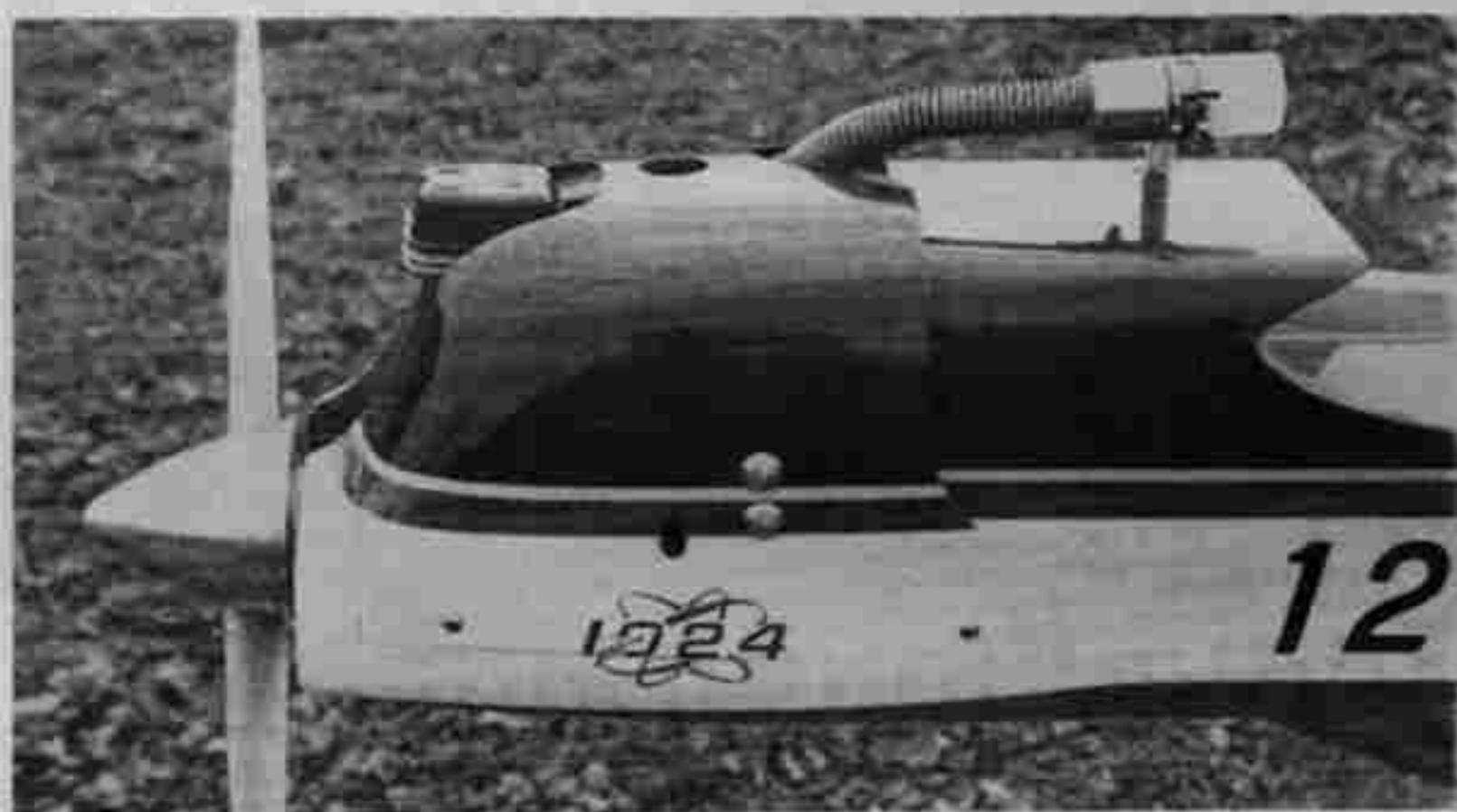
←写真7 / カウリングにスマートに収まったエンジン部。
