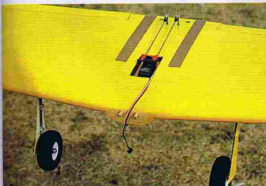
↑主翼中央部にエルロン・サーボを搭載。メイン・ギヤは固定式だが、脚カバー（キットはベニヤ製だが、本機は2mmアルミ板に変更）がスケール感の向上に一役かっている。
