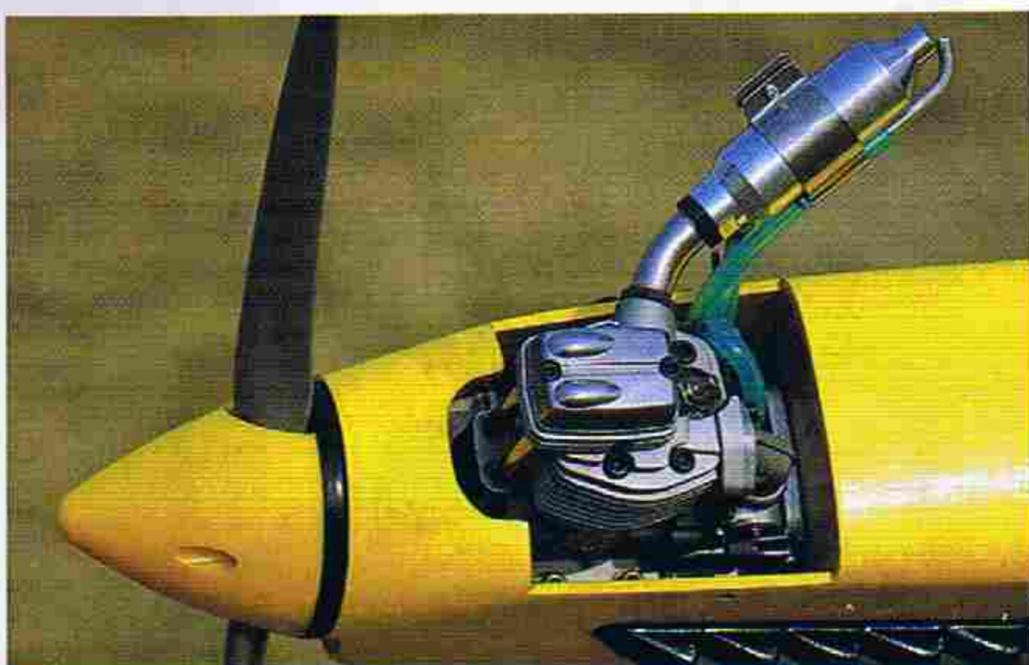
↑OS FS-48サーバスをIM製ラジアルマウントで搭載。排気管にドレン・パイプを固定し、エンジン内の余分なオイルは排気と一緒に吹き飛ばす。
