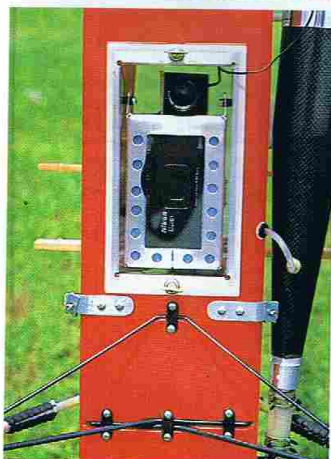
↑カメラはレンズを下向きにして胴体下面に搭載し、透明アクリル板でカバー。レンズの傾きはサーボでチルトできる仕組み。
