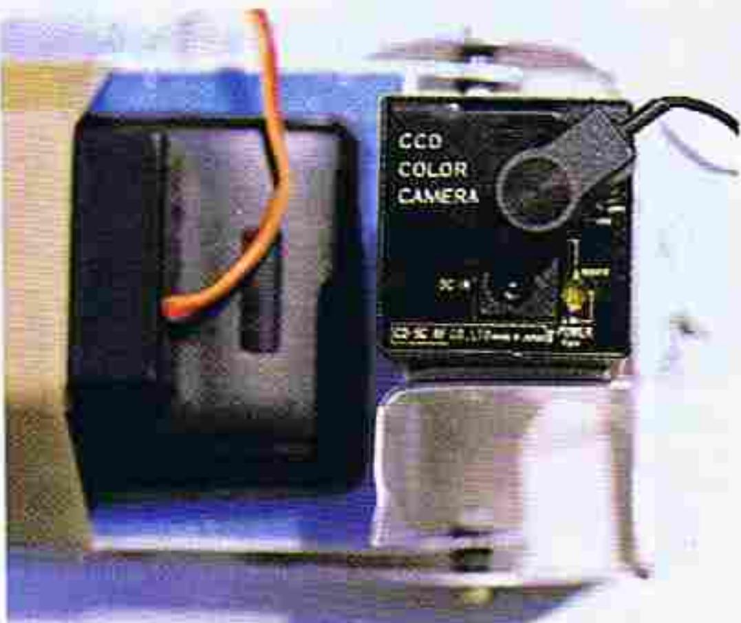
↓シャッターのリリーズは送信機右肩のスナップ・ボタン(5ch目にミキシング)、カメラの角度は右横のレバーで操作。
