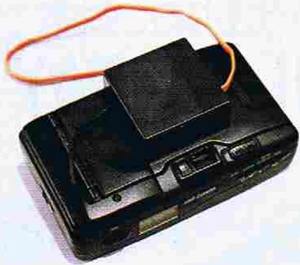
→甲南エレクトロニクス製の空撮用カメラ。ベースは世界最小・最軽量のニコン・ミニで、後面の箱は電気信号でシャッター・リリーズを可能にするアンプ。
