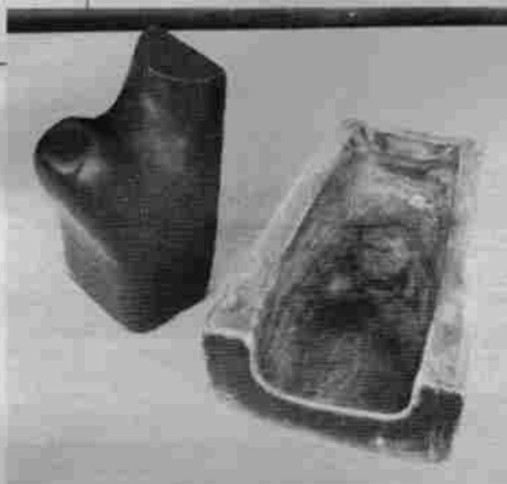
↑石膏より作られたカウルのメス型(右)とバルサ製の押し型(左)。
