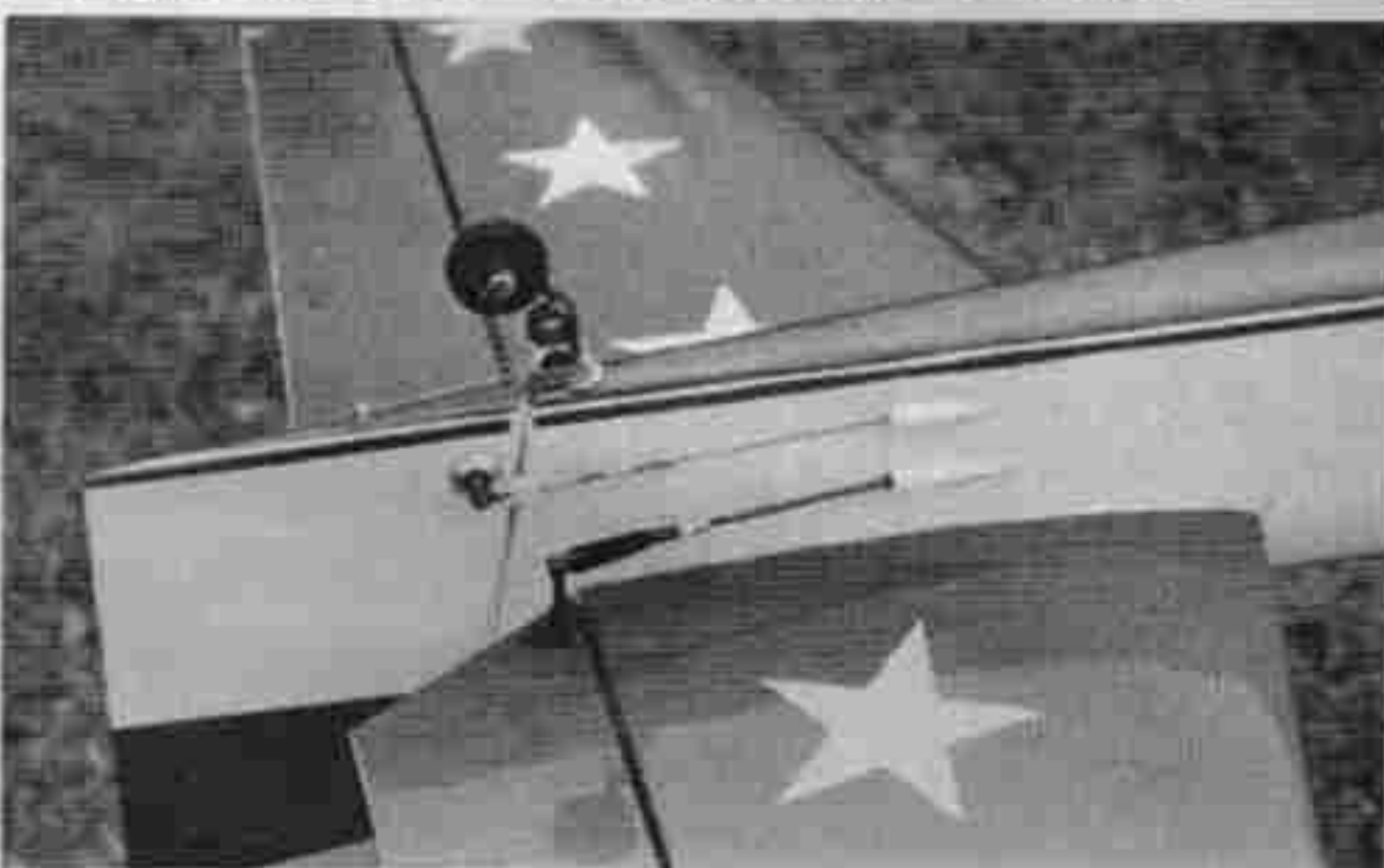
↓尾翼まわりのリンケージ。ラダーはワイヤーによる両引き式。これに連動する尾輪はヨシオカ製。
