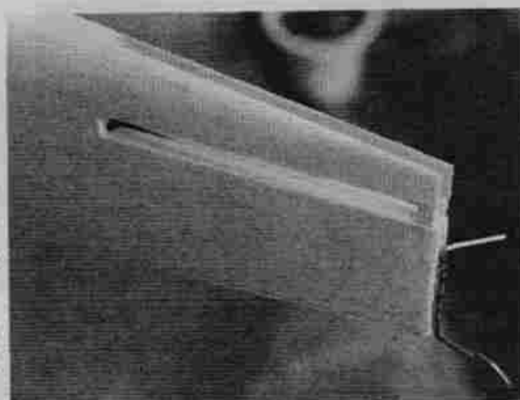
→写真5 / 胴体尾部。水平尾翼の厚み分のスクラップ・バルサを仮接着して、胴体と同時に整形する。また、尾輪の金具は必ずつま楊枝で固定しておく。
