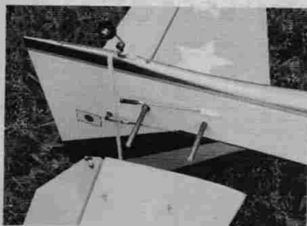
→写真17/このクラスの機体では、初の脱着式の水平尾翼を採用。取付角度も任意に微調整が可能だ。
