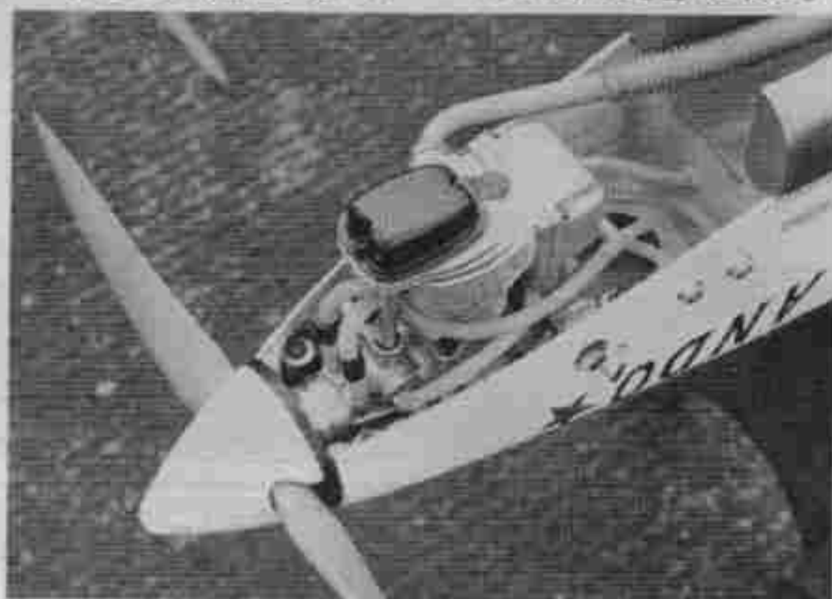
↓写真13/ハイパワーを誇るYS F91ACを搭載した機首回り。スペースが広く配管も楽だ。
