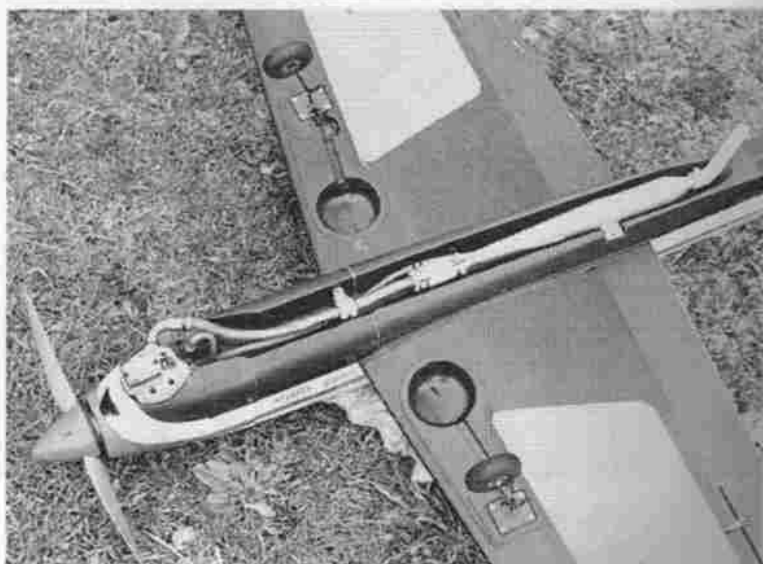
↑写真12/サイレンサー（テスト機はハットリ製4 C 120用）は冷却性の高い半埋め込み式。
