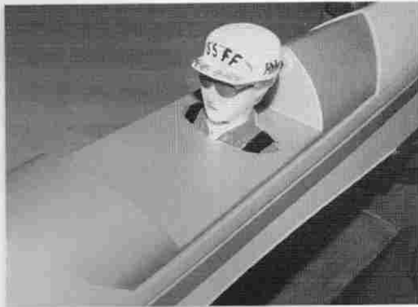
←写真10/カウリングは同社のヘリ・ボディにも採用されているタフレックス製の丈夫なもの。ただしABSに比べ若干肉厚が薄いので、テスト機では内部にグラスクロスを間接着剤で貼り、補強してみた。
