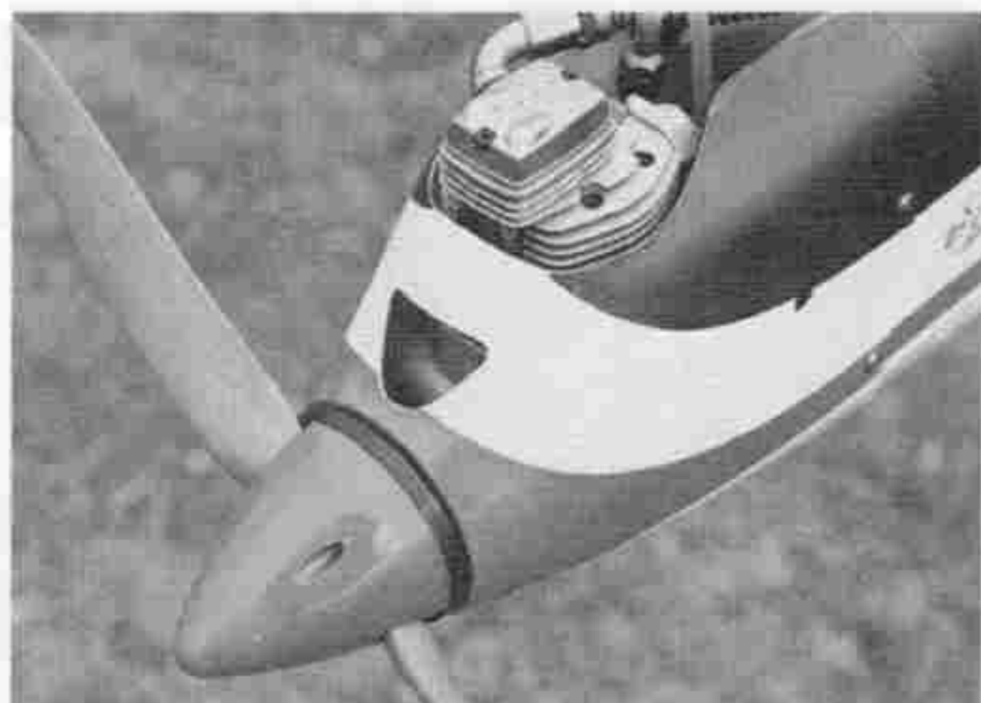
←写真11/カウリングの前面にエア・インテークを設けた。プロペラはA P C 12.5×10。
