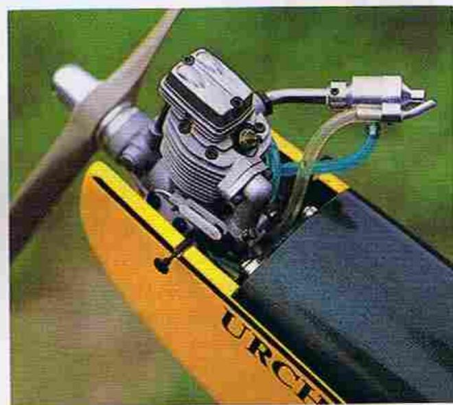
↑名エンジンとして定評のあるOS FS-26サーパスを簡易なラジアル・マウントで搭載。オーソドックスな正立スタイルのため、メンテナンス性も良好だ。
