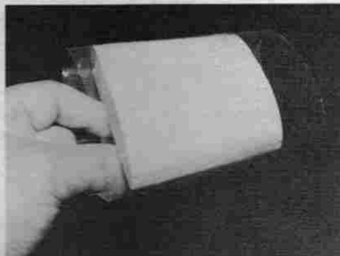
↑写真3 / キャノピーは、エンビ板をバルサの型に押し付け、カーブを付けて製作。
